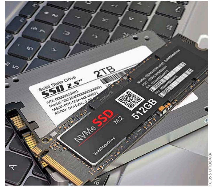
SSD-Karten: Die Solid State Disk waren ab 2007 marktreif. Sie basieren auf Halbleiterbausteinen und können bis zu 100 Terabyte speichern.
